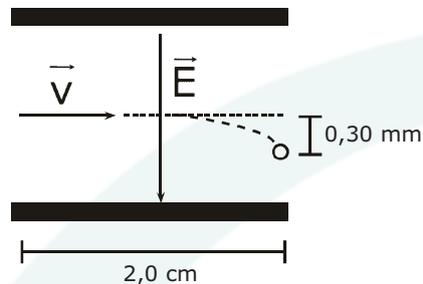
Considerando que a densidade da gota seja de  $1\,000 \text{ kg/m}^3$  e sabendo-se que a mesma sofre um desvio de  $0,30 \text{ mm}$  ao atingir o final do percurso, o módulo da sua carga elétrica é de
